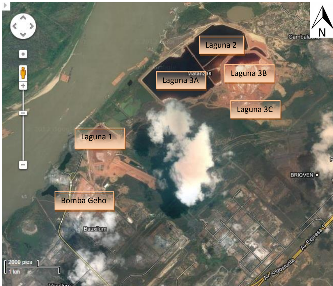
Fig. 2. Lagunas de Almacenamiento de Lodos Rojos. Tomado y modificado de Google earth, 2013.
