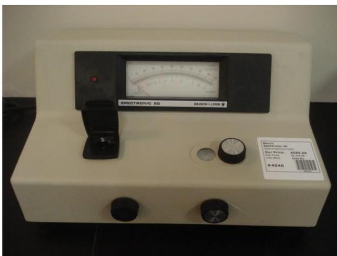
**Figura 9:** Equipo para la técnica de fotocolorimetría. Spectronic 20 Bausch & Lomb
