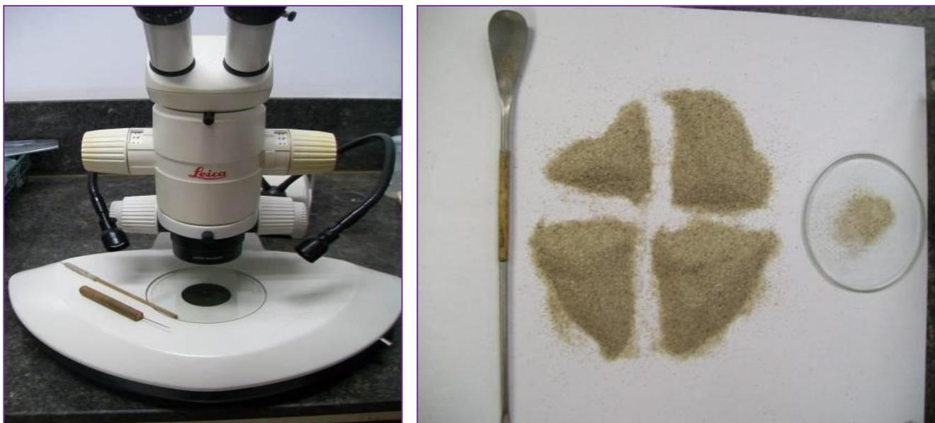
**Figura 13.** Lupa binocular Leica Mz125 (izquierda) y cuarteo y toma de muestras (derecha).
