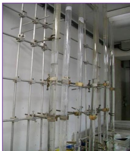
**Figura 12.** Materiales empleados en la separación granulométrica (tamices y columnas de sedimentación).
