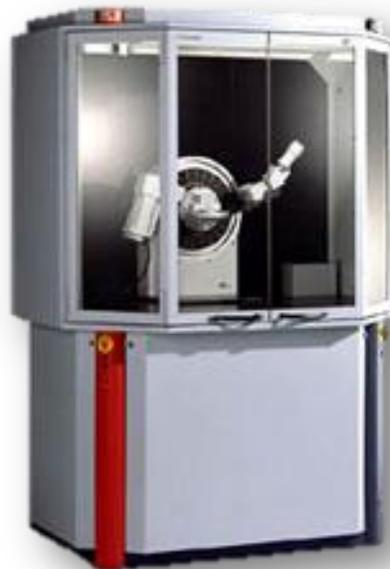
**Figura 15.** Difractómetro de rayos X, marca Bruker, modelo D8 Advance.
