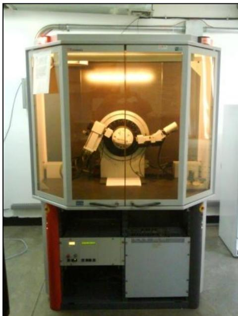
Figura 8. Equipo de DRX, marca Siemens, modelo AXS Bruker D8 advance
