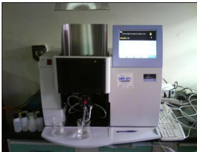
Figura 7. Equipo de EEA, Perkin Elmer, modelo 200
