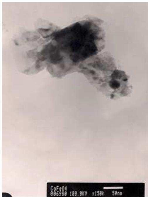
**Figura IV-21.** Imagen de campo claro de  $CoFe_2O_4$ . Preparada por el método de combustión.
