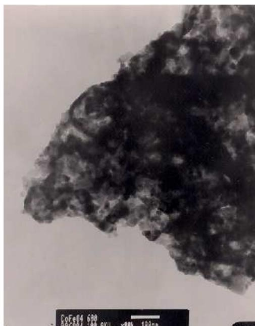
**Figura IV-22.** Imagen de campo claro de  $CoFe_2O_4cal\ 600$ . Preparada por el método de combustión.
