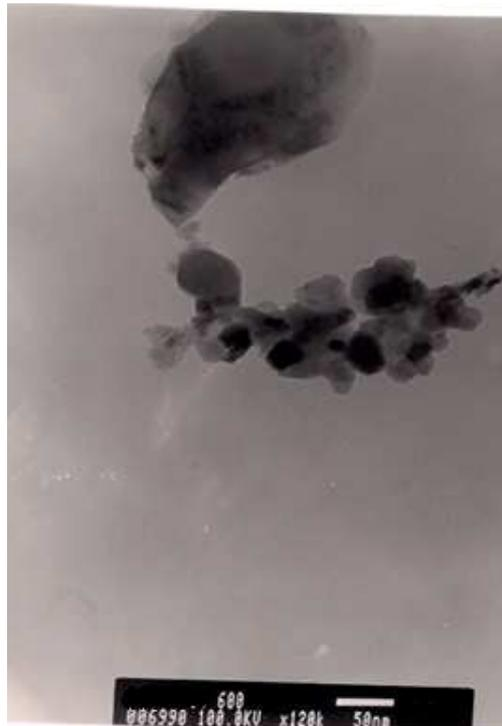
**Figura IV-24.** Imagen de campo claro de  $Ni_{0.5}Co_{0.5}Fe_2O_4$ . Cal 600 °C. Preparada por el método de combustión.
