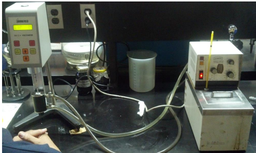
Figura 12 Fotografía del montaje de equipos utilizado para determinar la viscosidad del producto.
