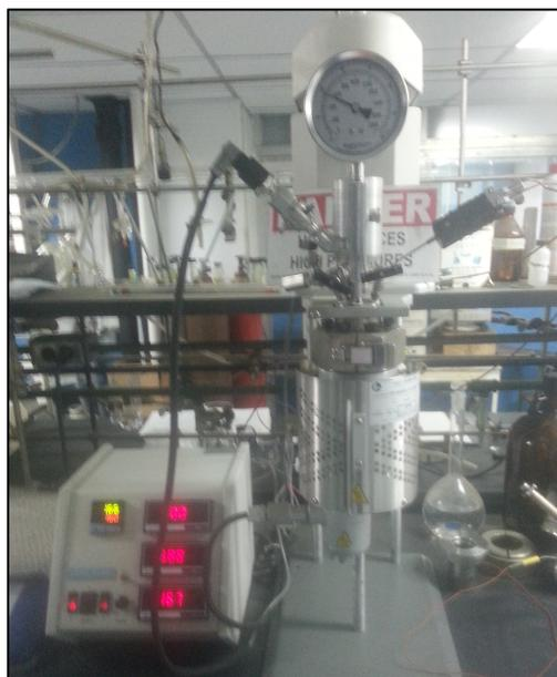
*Figura No. 18: Montaje para la hidrogenación de cinamaldehído.*
