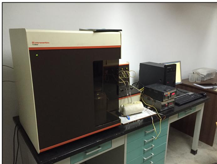
*Figura No. 19: Equipo de adsorción física de nitrógeno Micrometrics Tristar 3000.*
