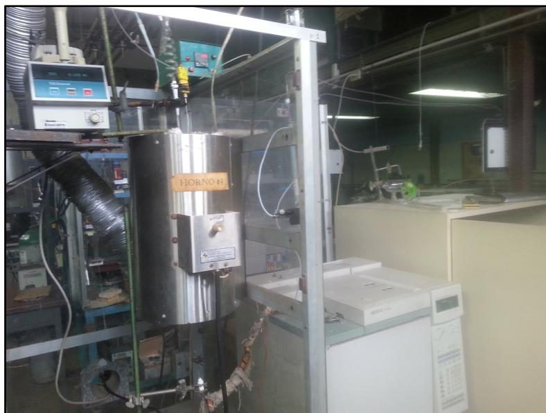
*Figura No. 17: Montaje para la hidrogenación de tolueno.*
