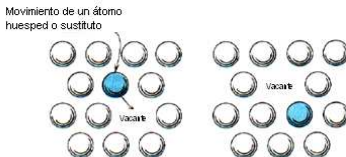
Figura 6. Esquema del mecanismo de difusión sustitucional de especies en redes cristalinas [24]
