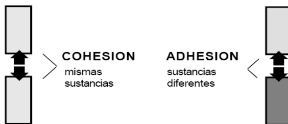
Figura 15. Diagrama esquemático sobre las fuerzas de cohesión y adhesión [38]
