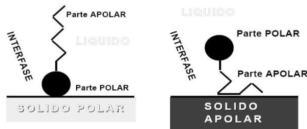
Figura 13. Esquema de la adsorción de una molécula de surfactante en una interfase sólido-liquido [38]
