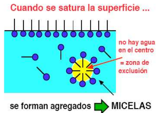
Figura 17. Formación de micela: agregado de moléculas de surfactante [39]
