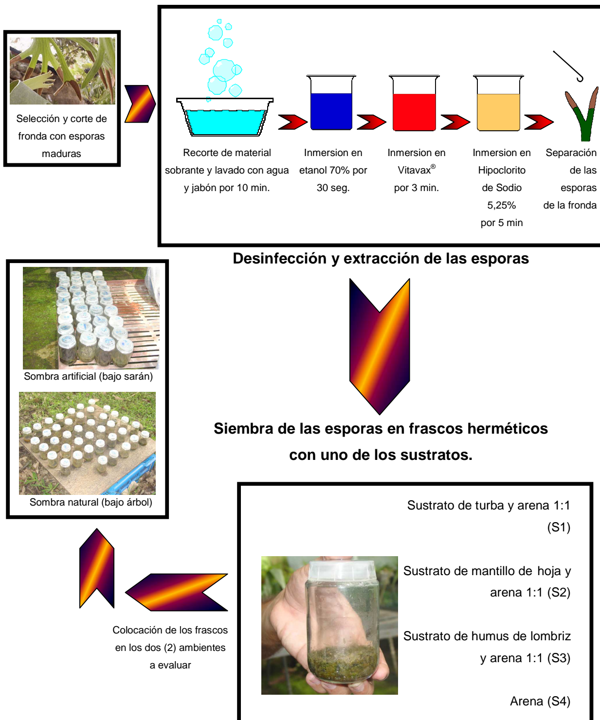
FIGURA 2: Extracción, desinfección y siembra de esporas de Platycerium bifurcatum in vivo en frascos herméticos en diferentes sustratos y ambientes.
