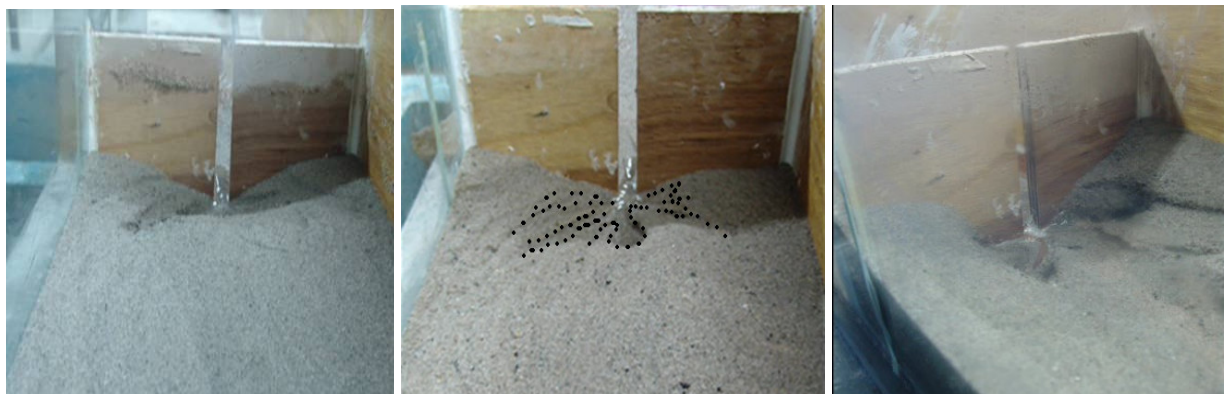
Foto 47. Forma de la cuña de sedimentos en las adyacencias a la abertura en presa ranurada. De Izquierda a derecha pendiente del canal 3, 5 y 7%.
