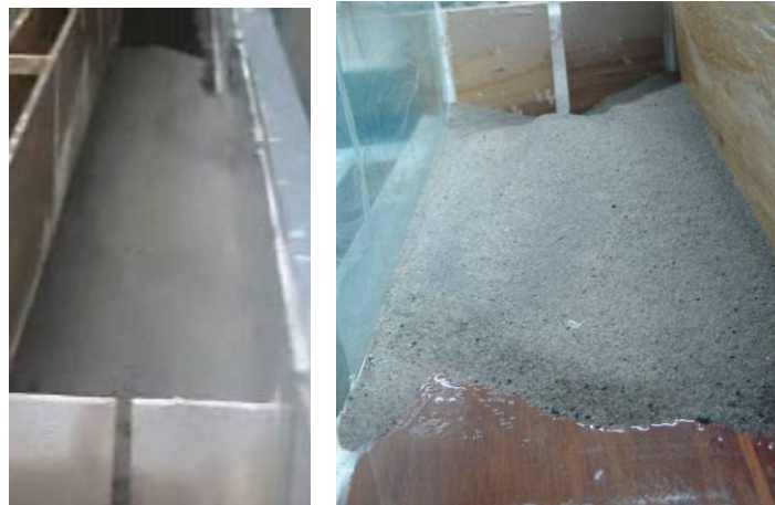
Foto 76. Escorrentía sobre presa Ranurada lodo de 1,42. Pendiente 3 y 7%.
