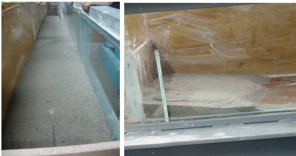
Foto 75. Escorrentía sobre presa de ventana después del paso de un lodo de densidad 1,42\text{gr/cm}^3 . De izquierda a derecha pendiente 3 y 7%
