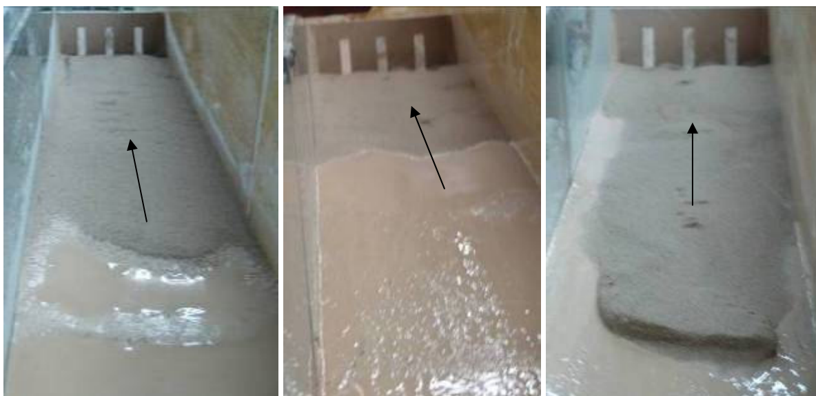
Foto 52. Lodo adherido sobre la cuña de sedimentos en presa de ventana. Densidad de lodo 1,25 \text{ gr/cm}^3 . Pendiente del canal 3, 5 y 7% de izquierda a derecha.
