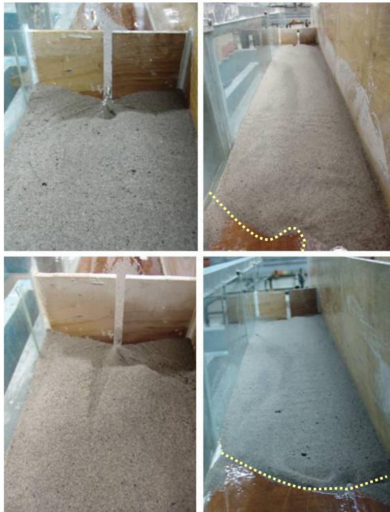
Foto 46. Vista de la cuña de sedimentos en presa ranurada para una inclinación del canal de 3%. De arriba hacia abajo antes del lanzamiento de lodo de densidad 1,42 y 1,25 gr./cm 3 respectivamente.
