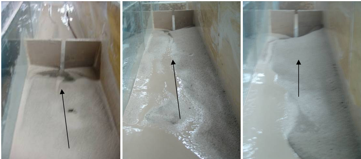
Foto 53. Lodo adherido sobre la cuña de sedimentos en presa ranurada. Densidad de lodo 1,42 \text{ gr/cm}^3 . Pendiente del canal 3, 5 y 7% de izquierda a derecha.
