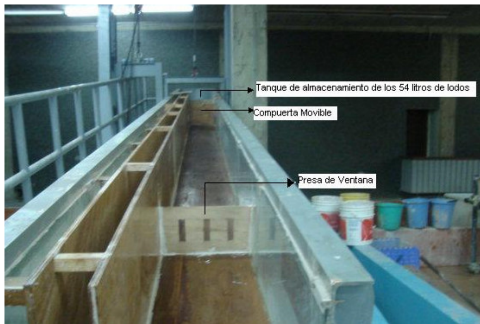
Foto 23. Partes del equipo experimental utilizado en el modelaje físico.
