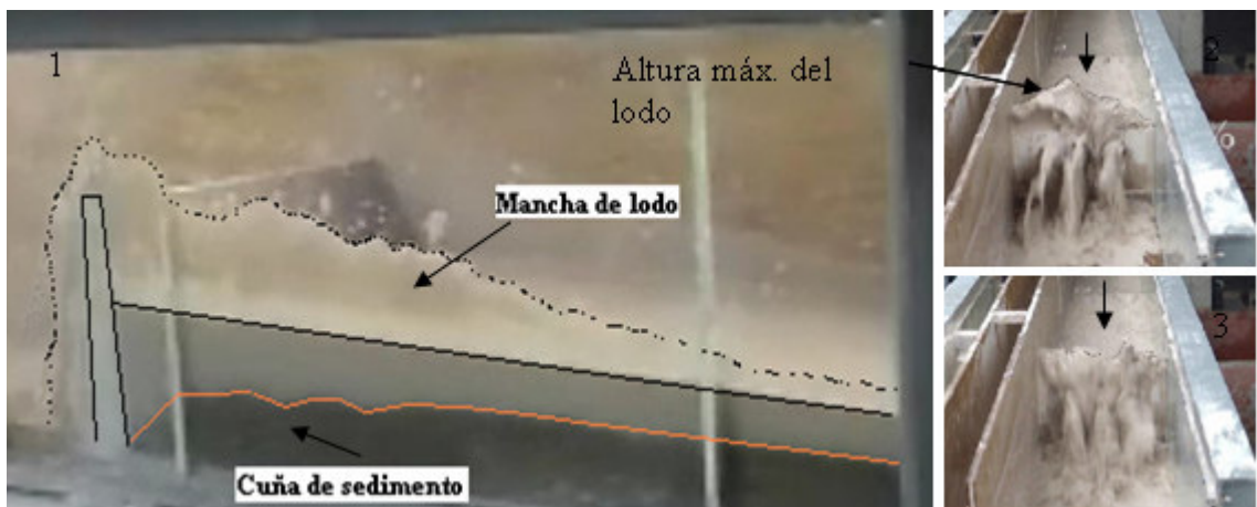
Foto 65. Vista de frente y de perfil del choque entre el lodo ( 1,42\text{gr/cm}^3 ) y la presa de ventana para una inclinación del canal de 3%.
