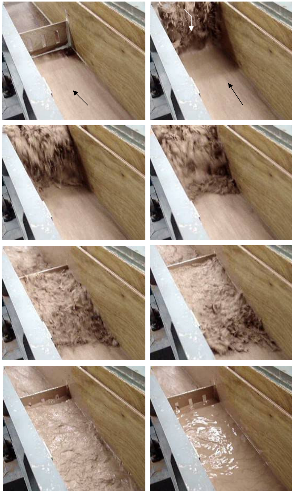
Foto 36. Secuencia del choque de la ola de lodo con la presa de ventanas vacía. Densidad de lodo 1,25 gr./cm 3 . Pendiente del canal 5%.
