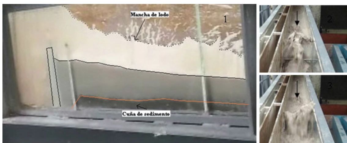
Foto 63. Vista de frente y de perfil del choque entre el lodo ( 1,25\text{gr/cm}^3 ) y la presa de ranurada para una pendiente del canal de 5%.
