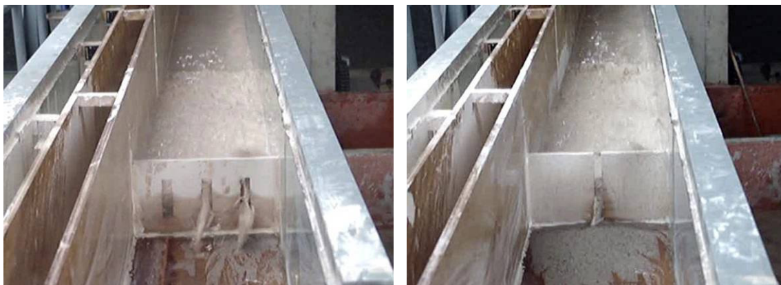
Foto 61. Impacto inicial del lodo con la presa. Densidad de lodo 1,42\text{gr/cm}^3 y pendiente del canal 3%. Presa de ventanas y ranurada, de izquierda a derecha.
