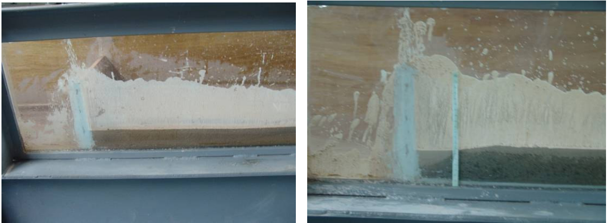
Foto 70. Mancha de lodo sobre presa ventana colmatada para pendiente de 3%. De izquierda a derecha densidad de lodo 1,25 y 1,42 g/cm 3 .
