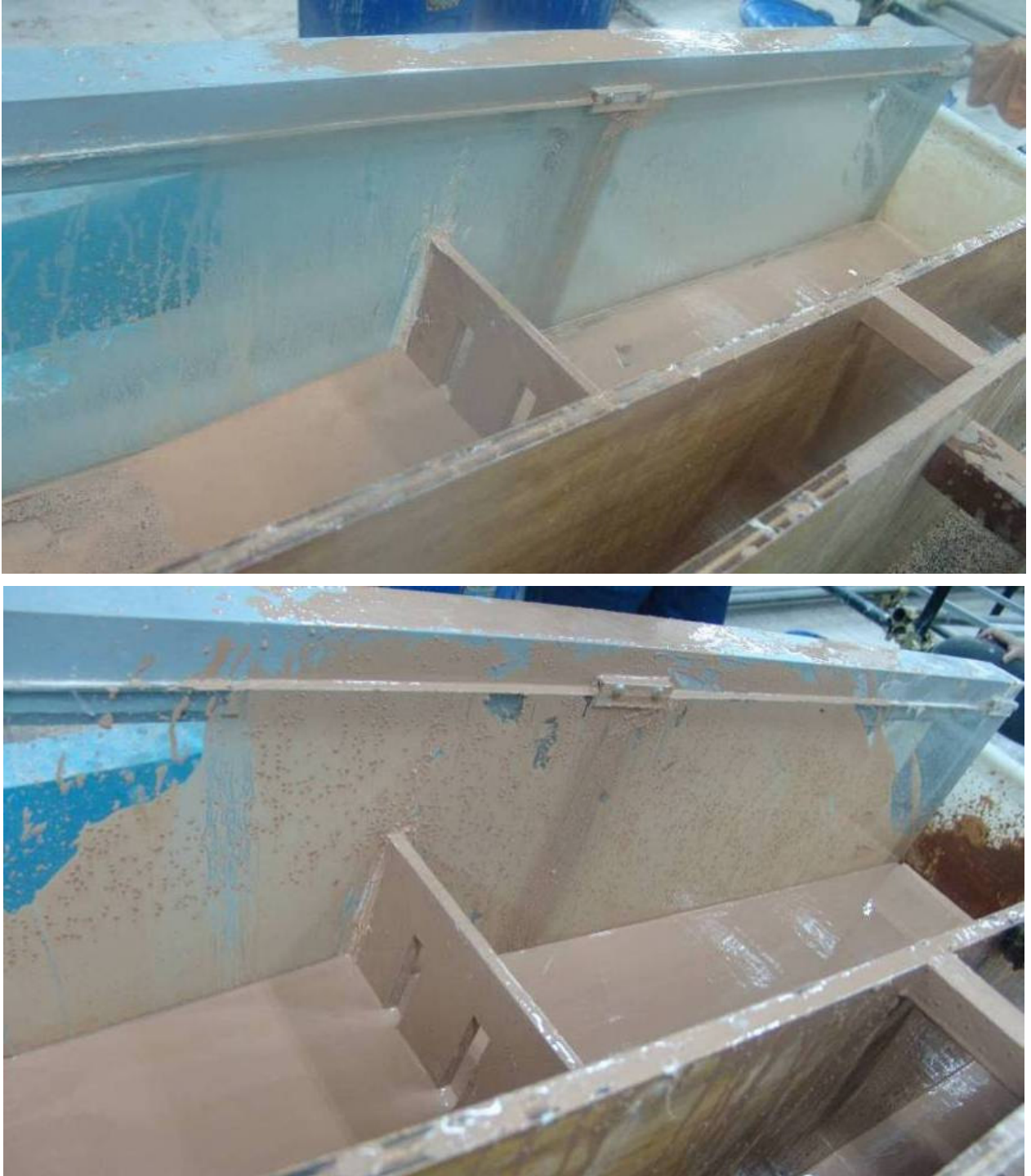
Foto 43. Vista de la mancha que deja el lodo por efecto del resalto sobre presa de ventana vacía. Pendiente del canal 7%. De arriba hacia abajo densidad del lodo 1,25 y 1,42 gr./cm 3 .
