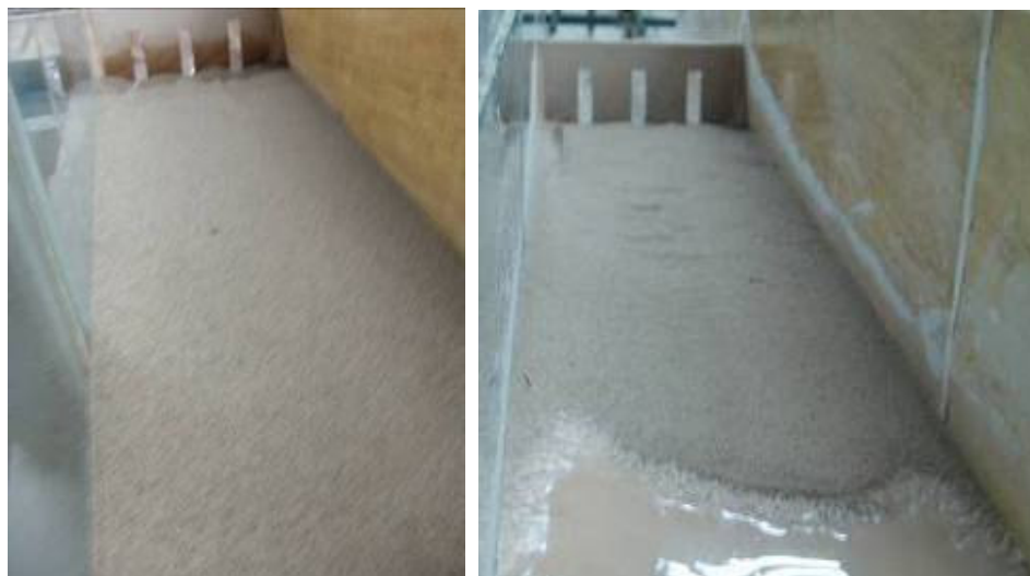
Foto 57. Cuña de arena e presa de ventanas para pendiente de 3%. De izquierda a derecha antes y después del paso del lodo de densidad 1,25 \text{ gr/cm}^3 .
