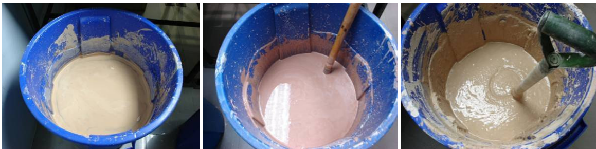
Foto 24. Muestras lodos de Cw 25%, 50%, 75%, de izquierda a derecha.
