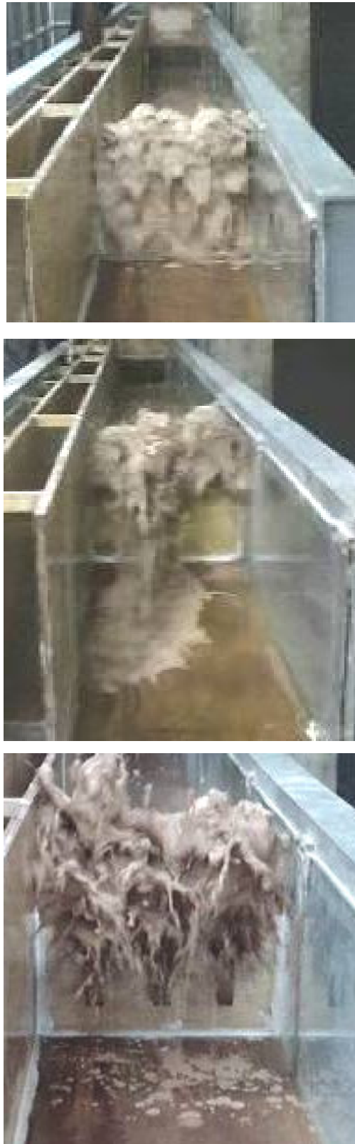
Foto 44. Comparación del tamaño del resalto formado en los tres tipos de presa. De arriba hacia abajo presa cerrada, ranurada y de ventanas. Densidad de lodo 1,42 gr./cm 3 . Pendiente del canal 5%.
