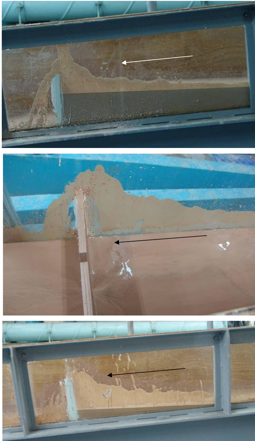
Foto 45. Vista de la mancha que deja el paso del lodo sobre las presas vacías. De arriba hacia abajo presa cerrada, ranurada y ventana. Pendiente 3%. Densidad de lodo 1,42 gr/cm 3 .
