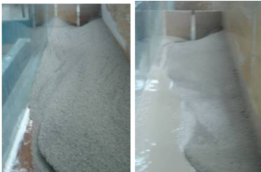
Foto 58. Cuña de arena en presa ranurada para pendiente de 3%. De izquierda a derecha antes y después del paso del lodo de densidad 1,25 \text{ gr/cm}^3 .
