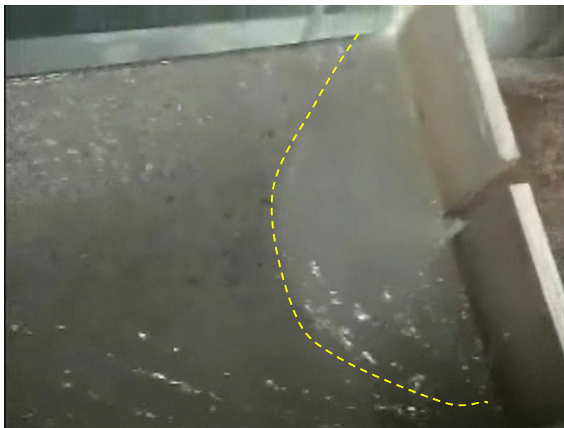
Foto 48. Turbulencia aguas arriba de la presa ranurada. Pendiente del canal de 3%.
