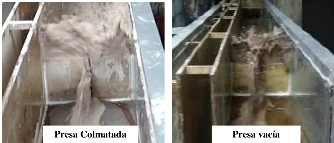
Foto 74. Tamaño del resalto en presa ranurada vacía y colmatada. Densidad de lodo 1,42\text{gr/cm}^3 . Pendiente del canal 5\% .
