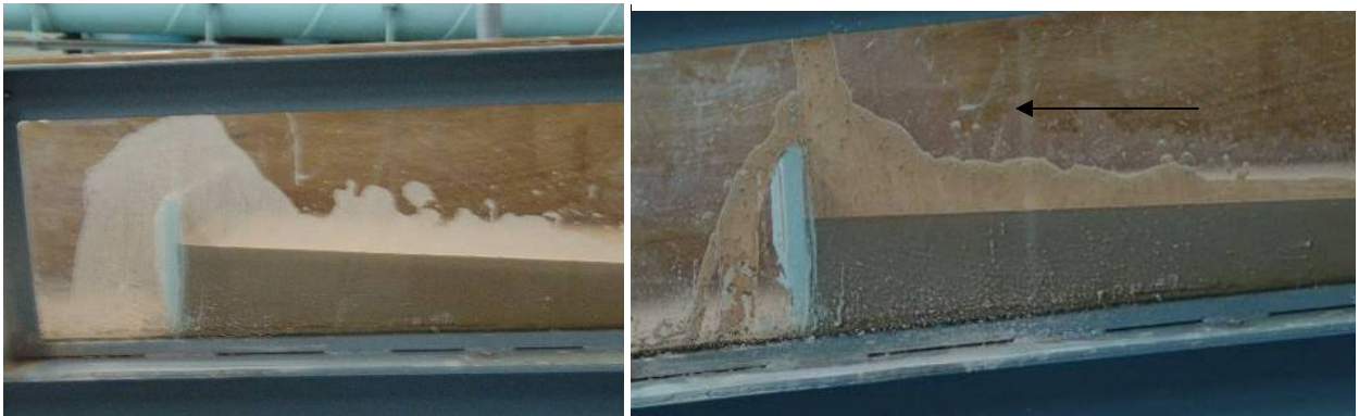
Foto 41. Vista del la mancha que deja el lodo por efecto del resalto en presa de cerrada vacía. Pendiente del canal 3%. Densidad de lodo 1,25 y 1,42 gr/cm 3 , de izquierda a derecha.
