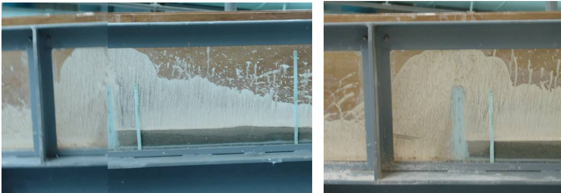
Foto 71. Mancha de lodo sobre presa ventana colmatada para pendiente de 5%. De izquierda a derecha densidad de lodo 1,25 y 1,42 g/cm 3 .
