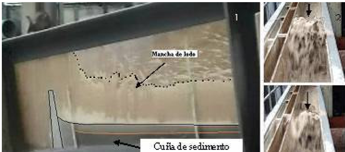
Foto 67. Vista de frente y de perfil del choque entre el lodo ( 1,42\text{gr/cm}^3 ) y la presa de ventana para una inclinación del canal de 7%.
