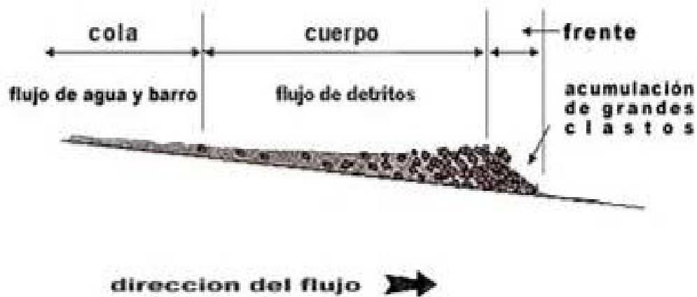
Figura 2. Diagrama esquemático de una onda típica de alud torrencial (Tomado de: Ingeniería Forense y Estudios de Sitio. Guía para la prevención de Gestión de Riesgos. Banesco Seguros (2006).
