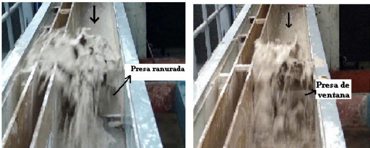
Foto 68. Desbordamiento de lodo en presas colmatadas. Pendiente del canal 7%. Densidad de lodo 1,25\text{ gr/cm}^3 .
