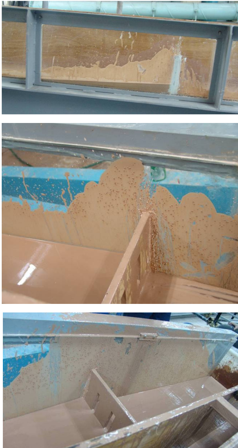
Foto 40. Vista del la mancha que deja el lodo por efecto del resalto en presa de ventana vacía. Densidad de lodo 1,42 \text{ gr/cm}^3 . De arriba hacia abajo Pendiente del canal 3, 5 y 7%.
