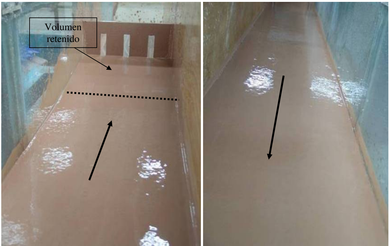
Foto 32. Retención del lodo aguas arriba de la presa de ventana. Pendiente del fondo del canal 5%. Densidad del lodo 1,42\text{gr/cm}^3 .
