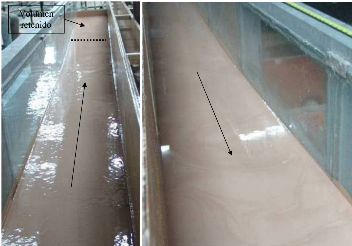
Foto 30. Retención del lodo aguas arriba de la presa cerrada. Pendiente del fondo del canal 3%. Densidad del lodo 1,42\text{gr}/\text{cm}^3 .
