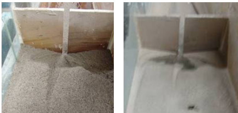
Foto 55. Depresión detrás de la presa ranurada colmatada en pendiente de 3%. De izquierda a derecha, antes y después del paso de lodo de densidad 1,42 \text{ gr/cm}^3 .
