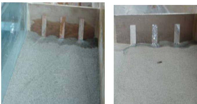
Foto 56. Depresión detrás de la presa de ventanas colmatada en pendiente de 5%. De izquierda a derecha, antes y después del paso de lodo de densidad 1,25 \text{ gr/cm}^3 .
