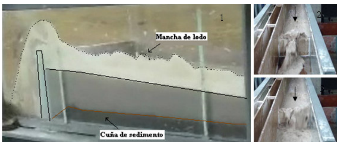
Foto 62. Vista de frente y de perfil del choque entre el lodo ( 1,25\text{gr/cm}^3 ) y la presa de ranurada para una pendiente del canal de 3%
