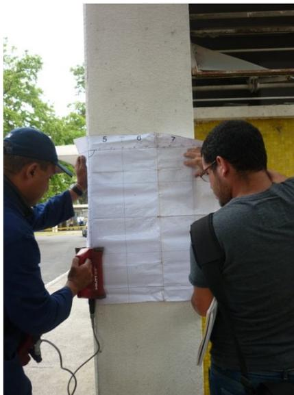
**Imagen 4.4. Obtención de Radiografías de la Columna C13**
