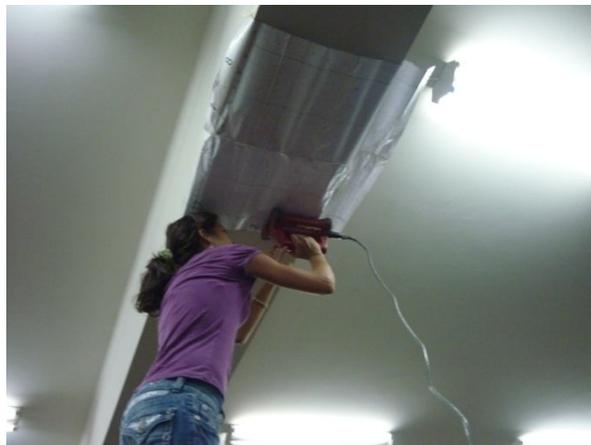
**Imagen 4.6 Obtención de Radiografías de la Viga del 3er Tramo de la Viga 1V4**
