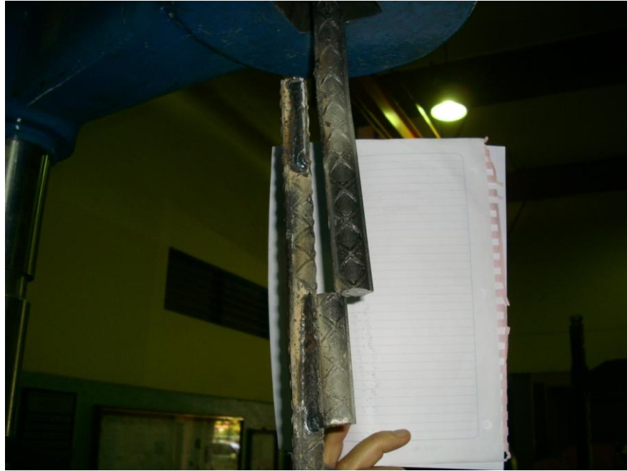
13.- Falla atípica entre las dos soldaduras de la muestra.
