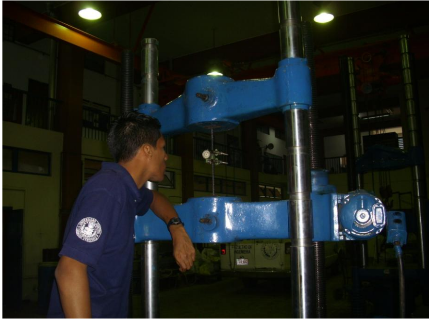
11.- Prensa Universal Baldwin (capacidad 1.200 – 30.000 kg)
