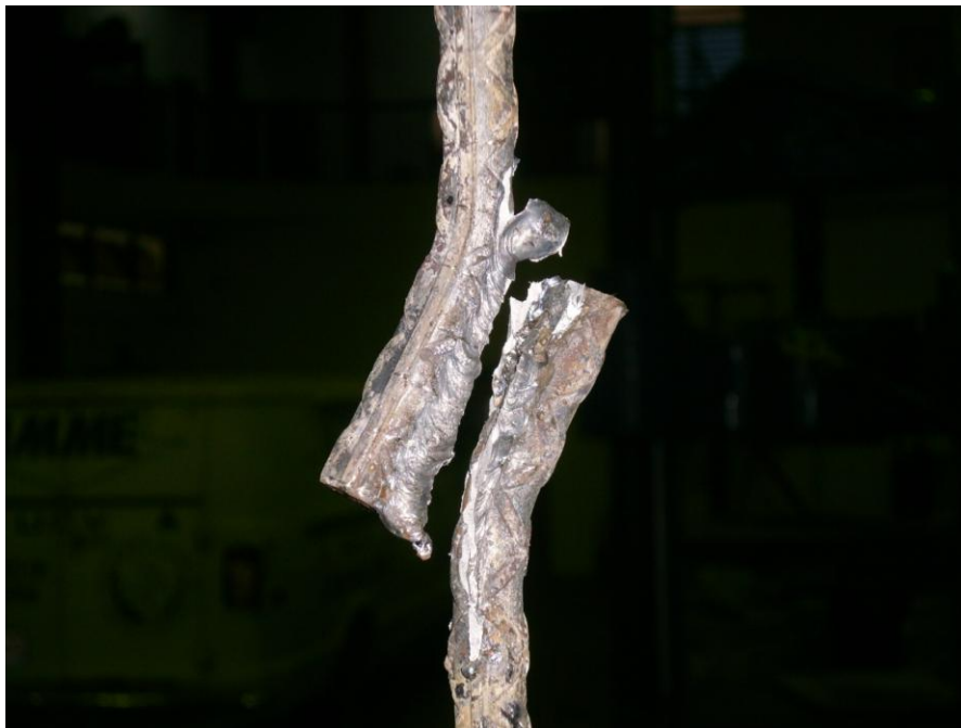
14.- Falla en la soldadura de la muestra.
