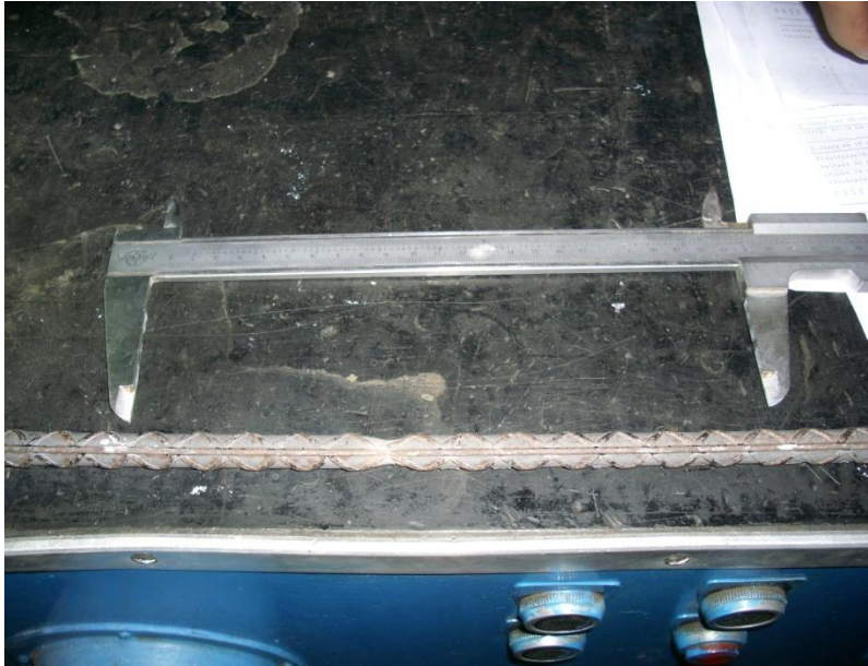
15.- Medición del alargamiento luego del ensayo.
