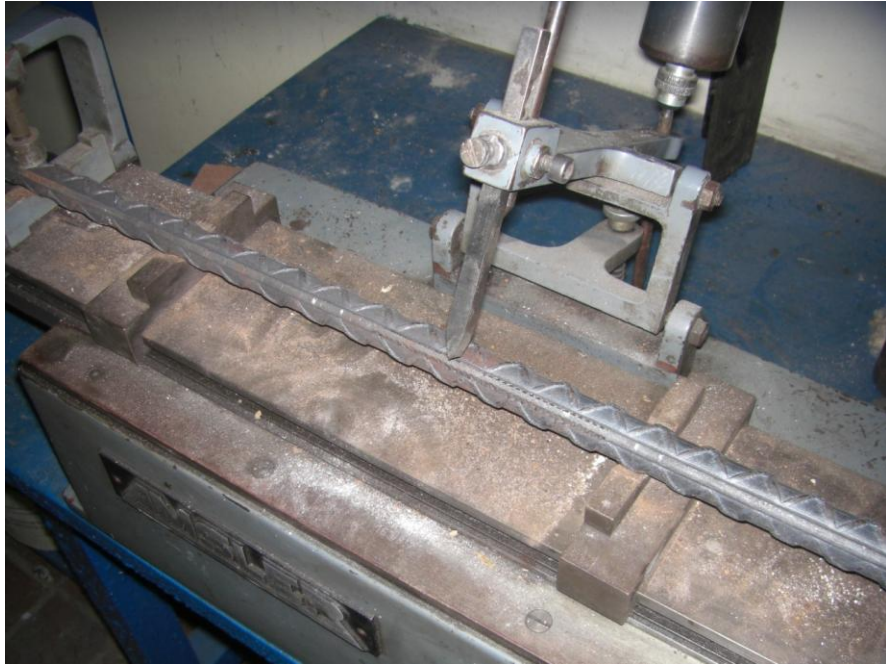
9.- Máquina AMSLER utilizada para marcar las barras
