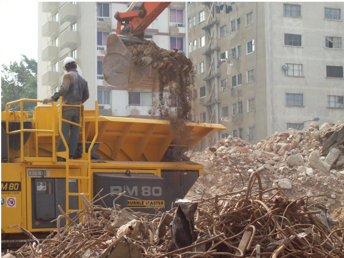
Foto N°1: Ilustración de la maquinaria Rubble Master RM-80, recibiendo residuos de materiales de construcción
