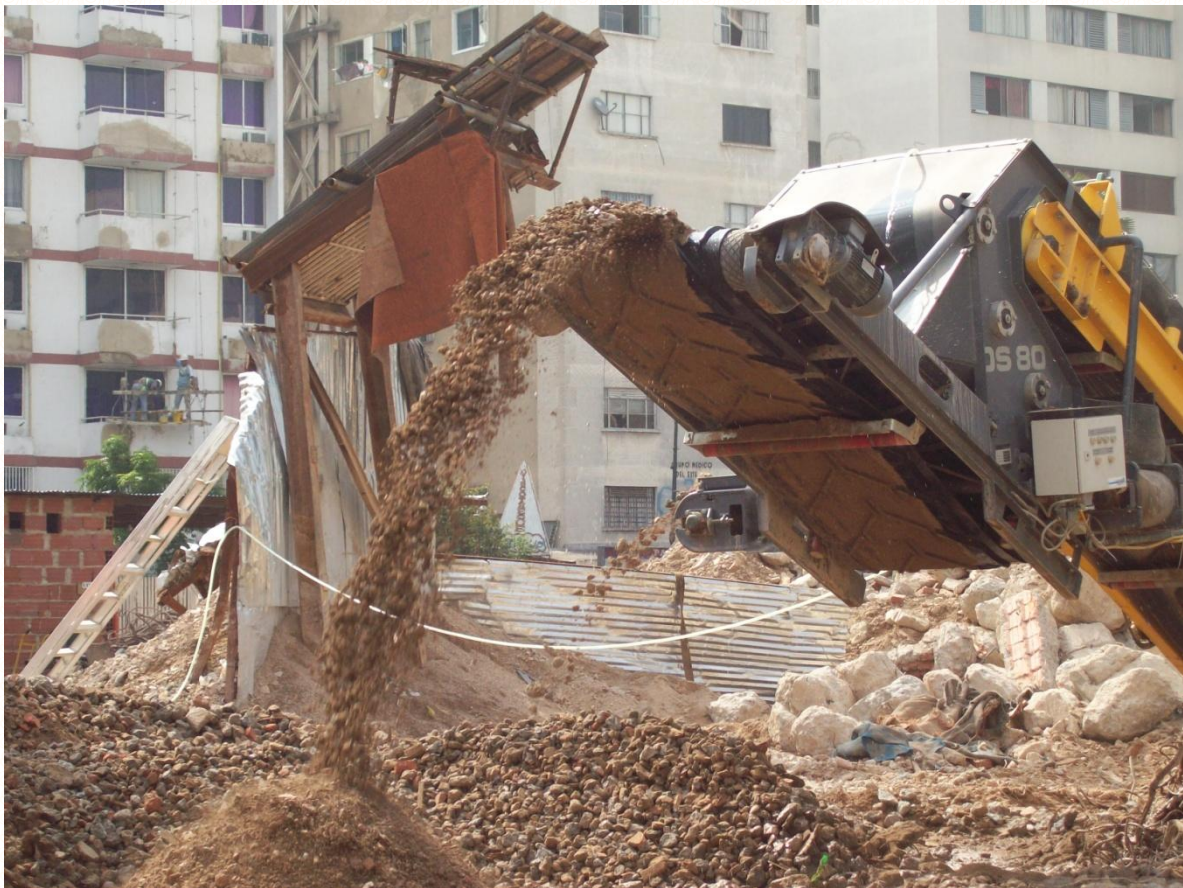
Foto N°5: Ilustración de los grupos de partículas que separa la cribadora: gruesas y finas
