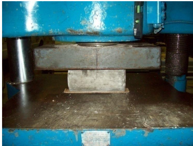
Foto N°19: Ilustración de la colocación de las probetas cilíndricas para realizar el ensayo de resistencia a la tracción indirecta
