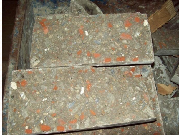
Foto N°20: Ilustración de una probeta ensayada a tracción indirecta, de la mezcla de resistencia de diseño de 250 \text{ kgf/cm}^2 , a la edad de ensayo de 7 días, con agregado Tipo I
