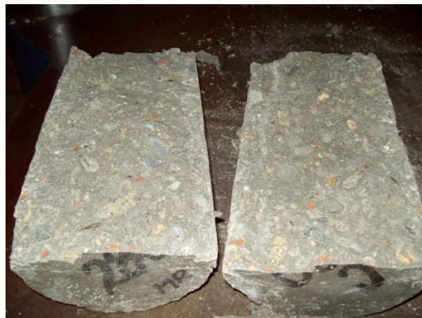
Foto N°21: Ilustración de una probeta ensayada a tracción indirecta, de la mezcla de resistencia de diseño de 280 \text{ kgf/cm}^2 , a la edad de ensayo de 7 días, con agregado Tipo II
