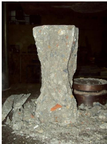
Foto N°17: Ilustración de una probeta ensayada a compresión, de la mezcla de resistencia de diseño de 280 \text{ kgf/cm}^2 , a la edad de 28 días, con agregados Tipo II. El cilindro presentó una falla de tipo (1), ver figura N°2
