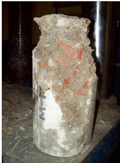
Foto N°15: Ilustración de una probeta ensayada a compresión, de la mezcla de resistencia de diseño de 210 \text{ kgf/cm}^2 , a la edad de ensayo de 28 días, con agregado Tipo I. El cilindro presentó una falla de tipo (4), ver figura N°2
