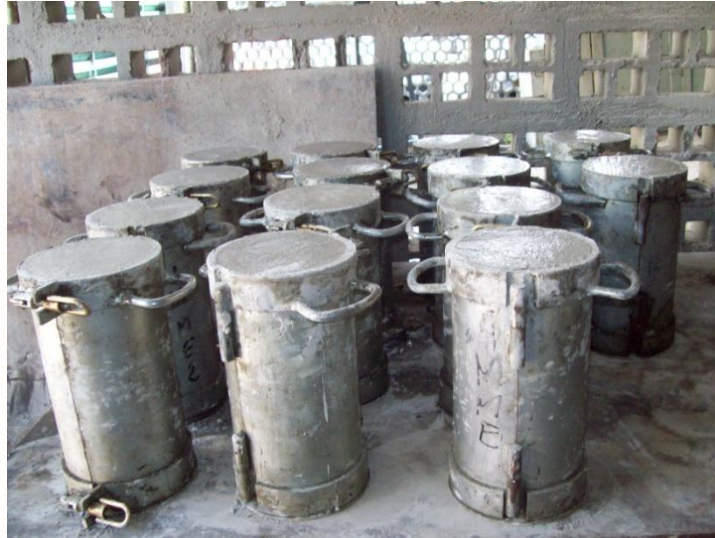
Foto N°12: Ilustración de probetas cilíndricas de la mezcla de resistencia de 250 kgf/cm 2 , con agregados Tipo II
