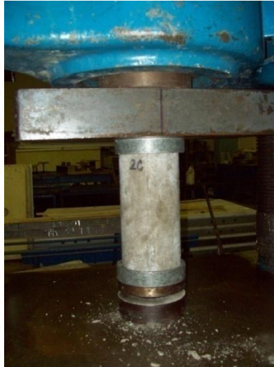
Foto N°13: Ilustración del ensayo de la colocación de las probetas cilíndricas para realizar el ensayo de resistencia a la compresión simple
