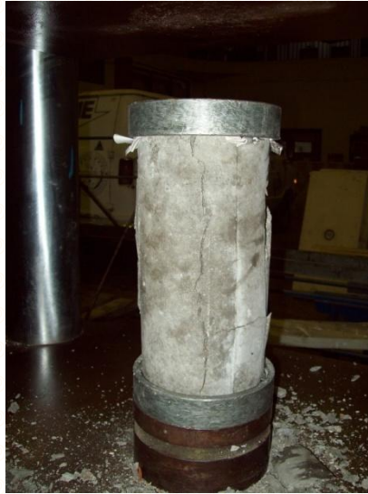
Foto N°18: Ilustración de una probeta ensayada a compresión, de la mezcla de resistencia de diseño de 280 kgf/cm 2 , a la edad de 7 días, con agregados Tipo II. El cilindro presentó una falla de tipo (3), ver figura N°2
