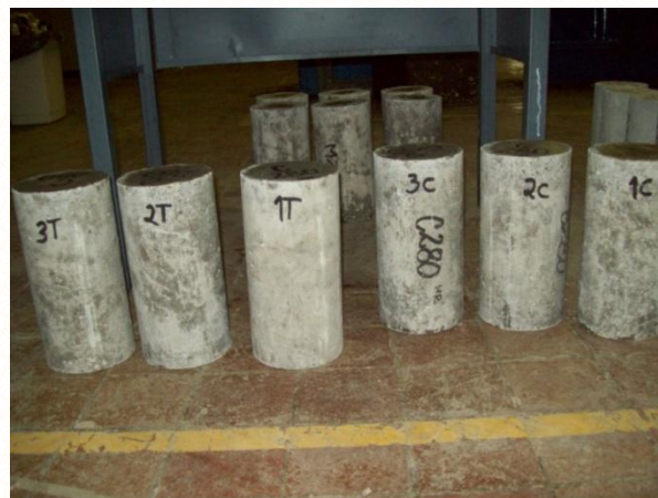
Foto N°14: Ilustración de las probetas de la mezcla de resistencia de diseño f_c=280 \text{ kgf/cm}^2 , con agregados Tipo II, edad de ensayo a los 28 días
