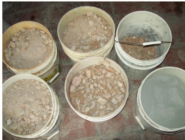
Foto N°10: Ilustración de la dosificación de agregados y cemento de la mezcla de 210 \text{ kgf/cm}^2 , con agregados Tipo I
