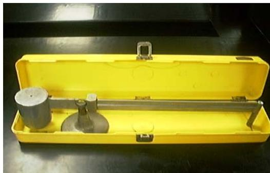
**Figura # 3.3 Balanza de lodos**
