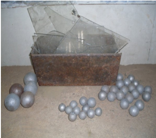
Fig. 3.17: Trozos de vidrio, material corrosivo para el curado del barril y esferas.
