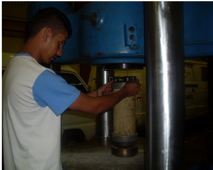
Fig. 3.26: Colocación de cilindros en la máquina de ensayo.
