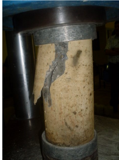
Fig. 4.5: Falla por corte
