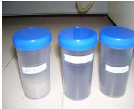
Fig. 3.23: Muestras de cemento Portland Tipo I, Ceniza seca y ceniza a temperatura ambiente.
