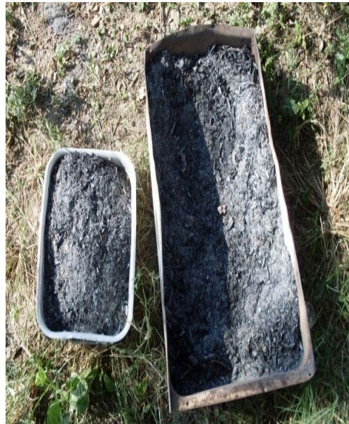
Fig. 3.12: Enfriamiento y oxigenación de la ceniza en bandejas metálicas.
