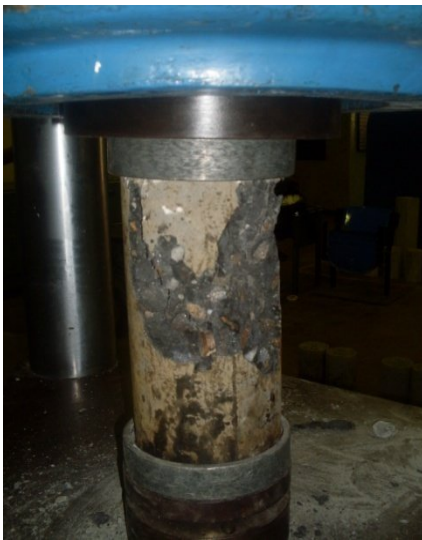
Fig. 4.4: Falla a compresión
