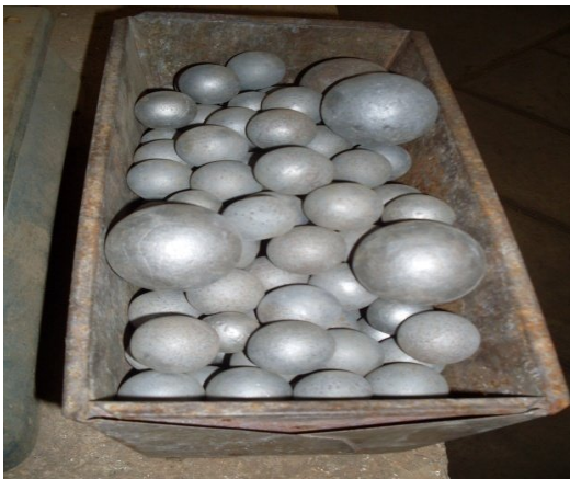
Fig. 3.15: Carga moledora, esferas de acero.
