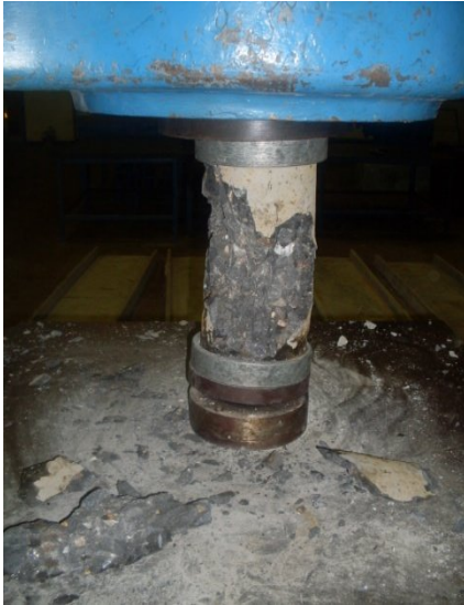
Fig. 4.3: Falla a compresión
