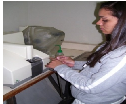
Fig. 3.24: Introducción de la muestra en la unidad de dispersión.
