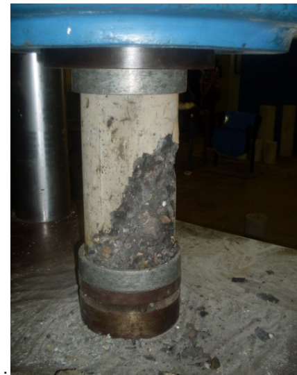
Fig. 4.6: Falla por corte
