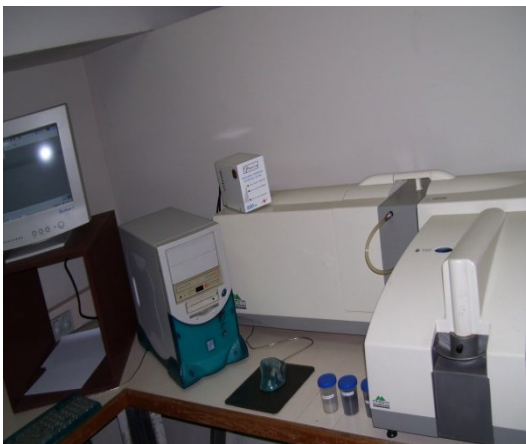
Fig. 3.21: Analizador de partículas MASTERSIZER 2000 de MALVERN-INSTRUMENTS. .
