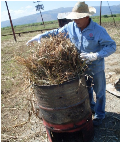
Fig. 3.9: Introducción del paquete de hojas de maíz secas en el contenedor de horno.
