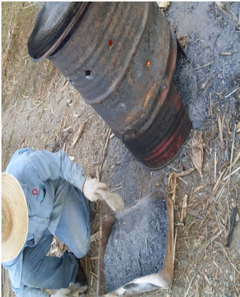
Fig. 3.11: Extracción de la gaveta contenedora colmada de ceniza para se vaciada en bandejas.
