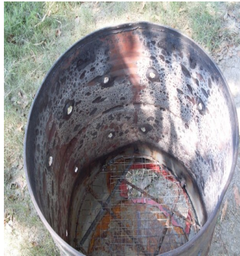
Fig. 3.6: Parte interior del horno para la incineración de hojas de maíz, base contenedora, y orificios para ventilación.
