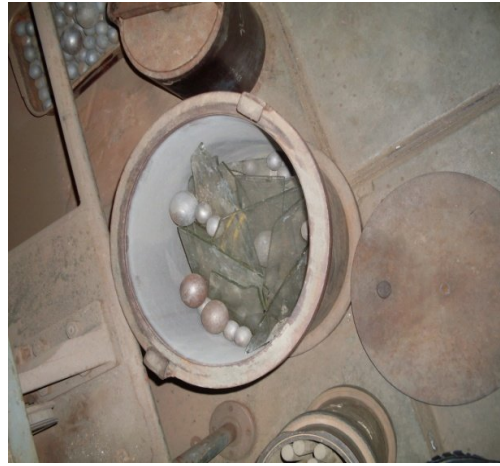
Fig. 3.18: Introducción en el barril de la carga moledora y el vidrio.
