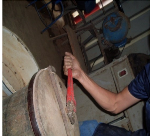
Fig. 3.20: Cierre del barril conteniendo la ceniza y la carga moledora respectiva.
