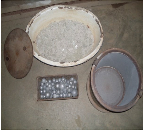
Fig. 3.19. Extracción del vidrio del barril luego de su proceso de curado corrosivo.
