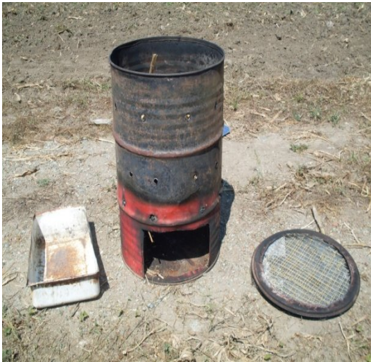
Fig. 3.5: Horno para incineración de las hojas de maíz, gaveta extraíble para acumulación de ceniza y tapa de protección.
