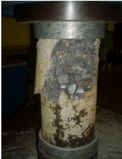
Fig. 3.27: Probeta cilíndrica ensayada
