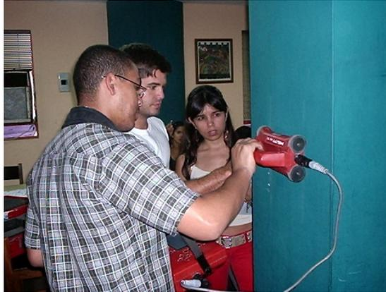
**Figura IV.2.17** – Foto Ubicación de Acero en Columna con el Ferroskan FS10.
