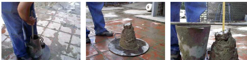
Foto 3.17. Medición del asentamiento de la mezcla con el cono de Abrams.
