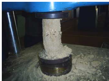
Foto 3.21. Ensayo de resistencia a la compresión.
