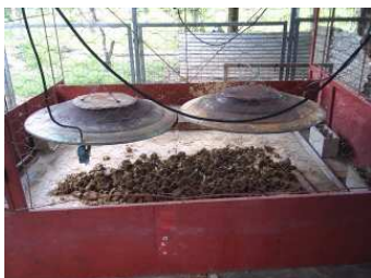
Foto 3.10. Disminución del contenido de humedad del lodo por medio del uso de estufas.
