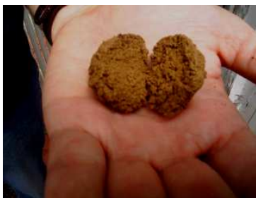
Foto 3.13. Muestra de lodo examinada con la prueba del brillo.
