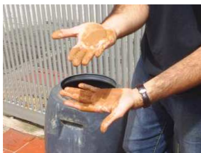
Foto 3.14. Muestra de lodo examinada con la prueba de la sacudida.
