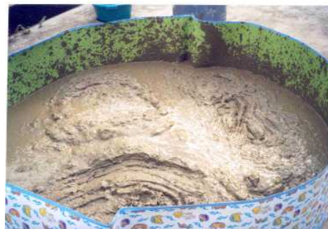
Foto 3.8. Disminución del contenido de humedad del lodo a la intemperie
