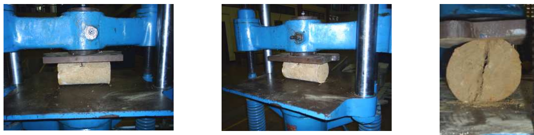
Foto 3.22. Ensayo de resistencia a la tracción indirecta.
