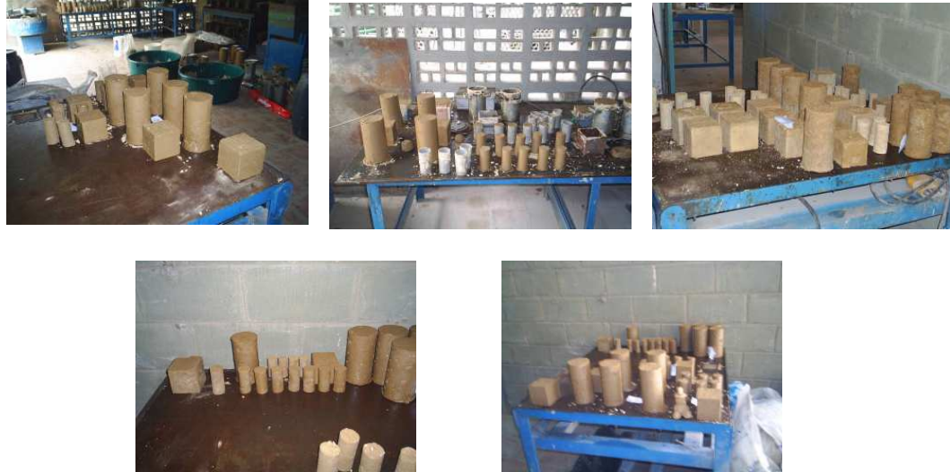
Foto 3.19. Almacenamiento de las probetas de lodo-cemento.
