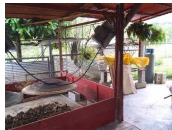
Foto 3.10. Disminución del contenido de humedad del lodo por medio del uso de estufas.
