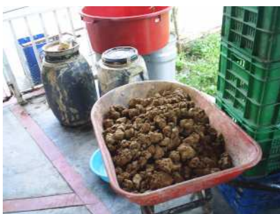
Foto 3.12. Lodo cuyo contenido de humedad fue disminuido con el uso de estufas.
