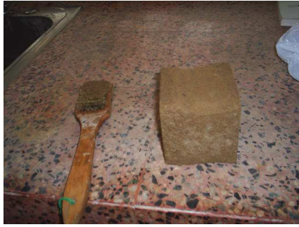
Foto 3.24. Ensayo de erosión por cepillado.
