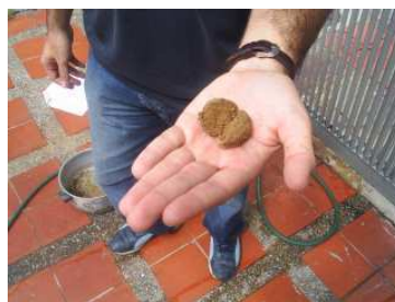
Foto 3.13. Muestra de lodo examinada con la prueba del brillo.
