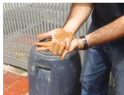
Foto 3.14. Muestra de lodo examinada con la prueba de la sacudida.
