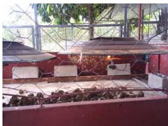
Foto 3.10. Disminución del contenido de humedad del lodo por medio del uso de estufas.
