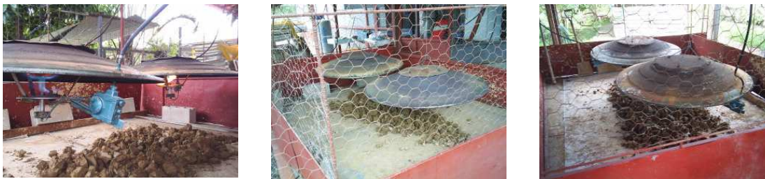
Foto 3.11. Disminución del contenido de humedad del lodo por medio del uso de estufas.
