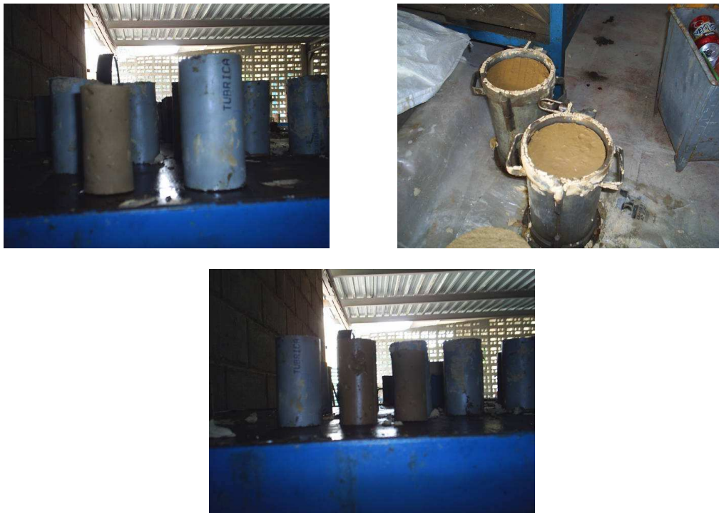
Foto 4.2. Proceso de fraguado del lodo-cemento.
