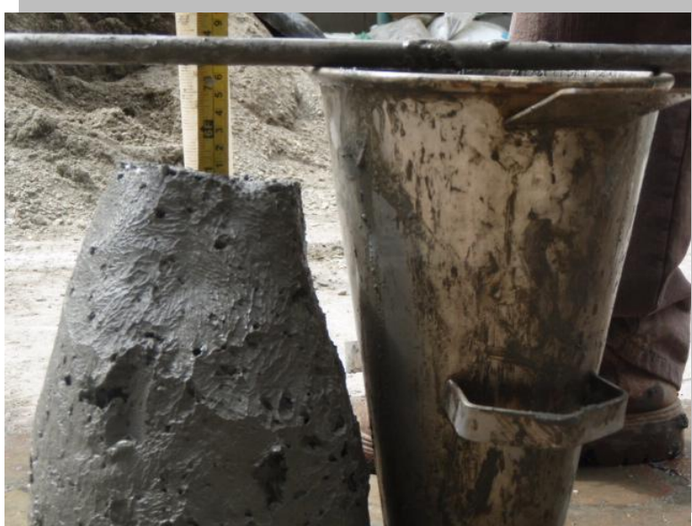
Imagen 10. Asentamiento de una mezcla con adición de microsíllice.
