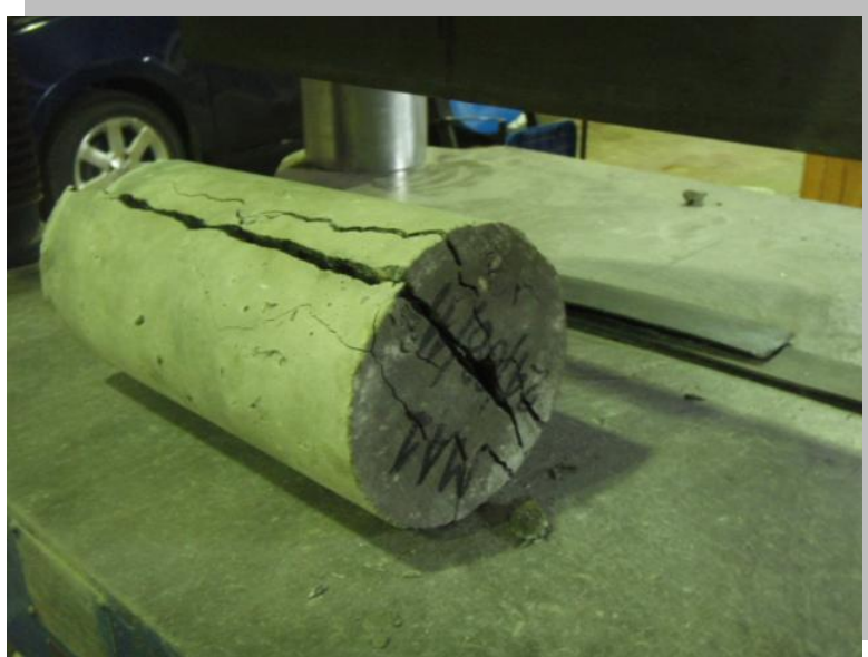
Imagen 20. Falla de la probeta luego del ensayo de Resistencia a la Tracción Indirecta.
