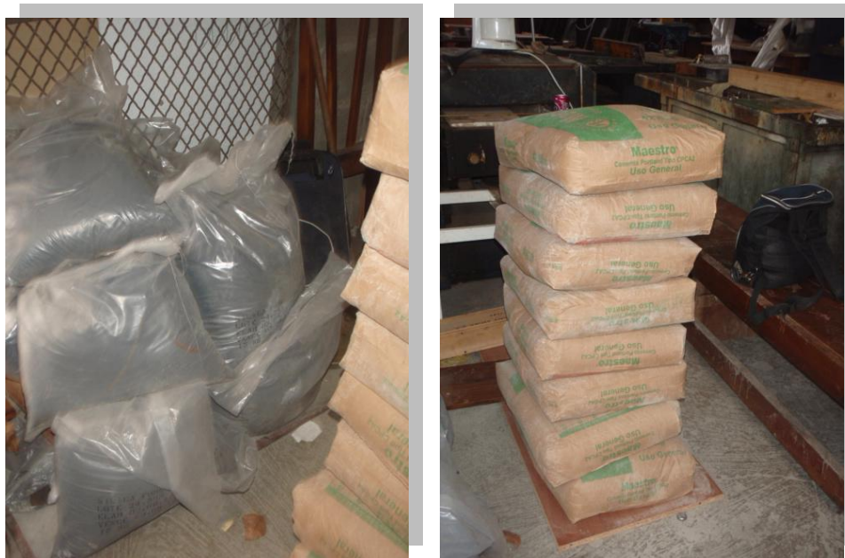
Imagen 3. Almacenamiento del cemento y el microsíllice.
