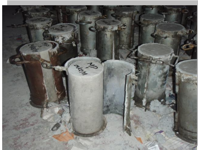
Imagen 13. Desencofrado de probetas.
