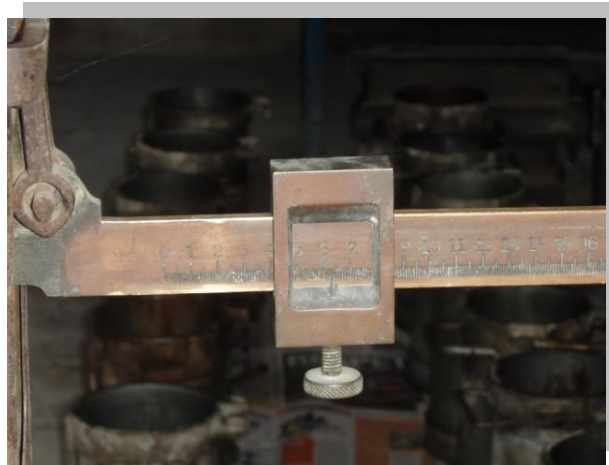
Imagen 5. Dosificación de componentes en peso. Indicador de la balanza empleada para el pesaje.
