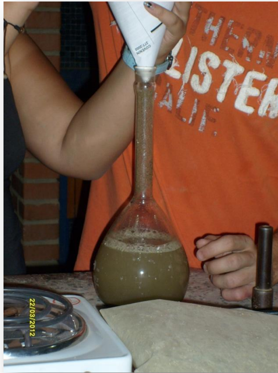
Foto # III.6 Colocación de la muestra de agregado fino dentro del picnómetro
