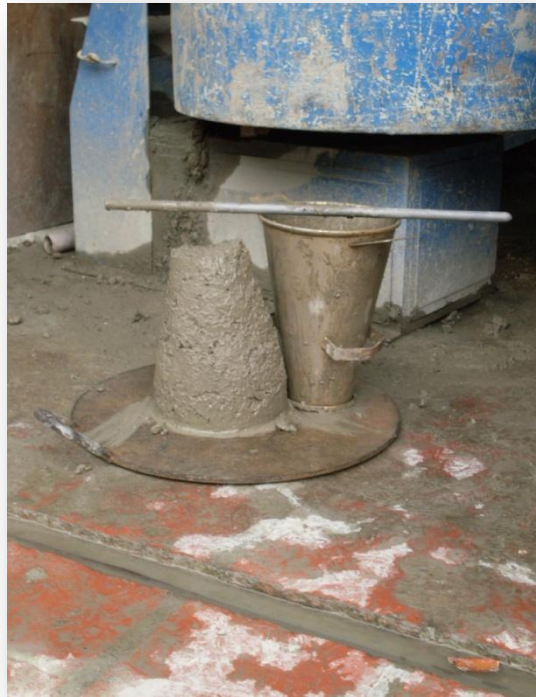
Foto # III.12 Ensayo del Cono de Abrams.
