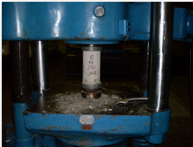
Foto # III.19 Probeta cilíndrica sometida al ensayo de compresión.
