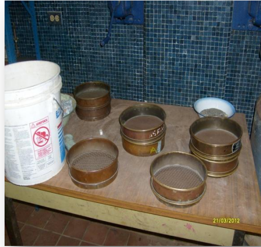
Fotos # III.3 y # III.4 Tamizadora mecánica para granulometría de agregado grueso. Cedazos para granulometría de agregado fino.
