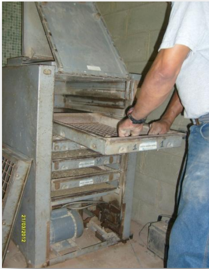
Fotos # III.3 y # III.4 Tamizadora mecánica para granulometría de agregado grueso. Cedazos para granulometría de agregado fino.
