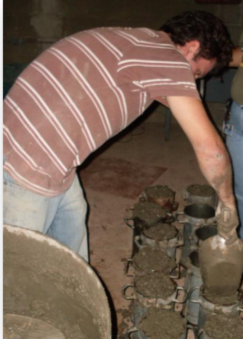
Foto # III.13 Vaciado de concreto en moldes metálicos.
