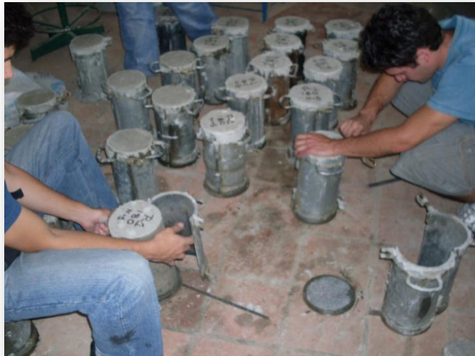
Foto # III.14 Desencofrado de probetas cilíndricas.
