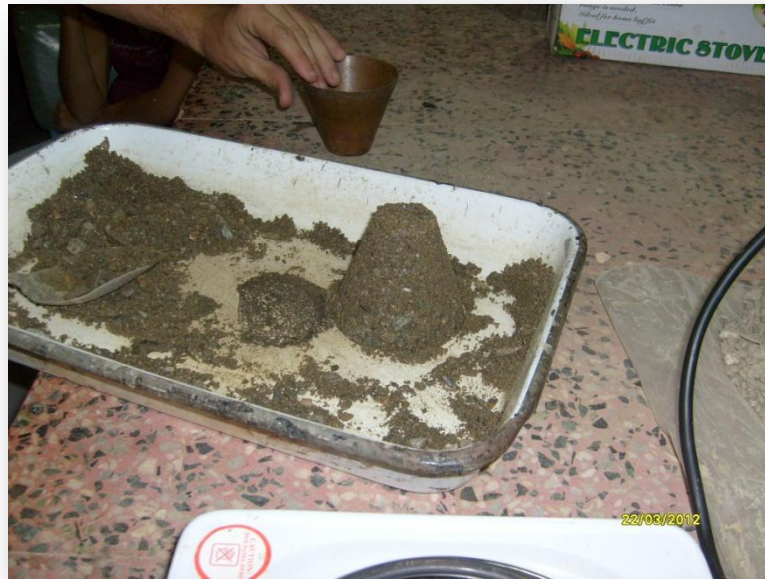
Foto # III.5 Ensayo del cono para determinar la condición de saturado con superficie seca del agregado fino.
