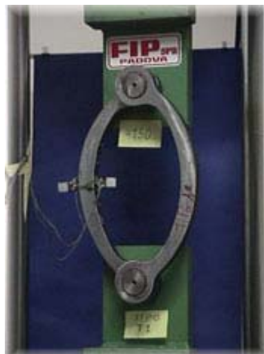
Figura 2.2.2: Dispositivo dissipatore a falce di luna;
