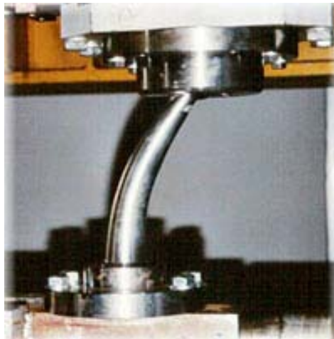
Figura 2.2.1: Dispositivo dissipatore a piolo;
