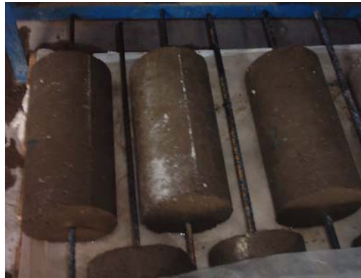
Foto 3.19. Ensayo de extracción. Almacenamiento hasta el ensayo.
