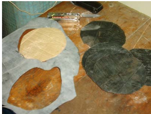
Foto 3.20. Ensayo de extracción. Goma delgada para colocarlo en la superficie del cilindro en contacto con la plataforma de la máquina de ensayo.
