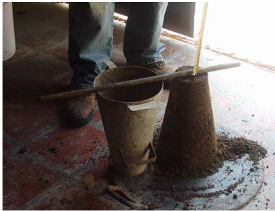
Foto 3.10. Medición del asentamiento.
