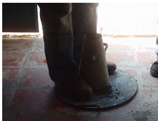
Foto 3.9. Asentamiento. Llenado de la mezcla
