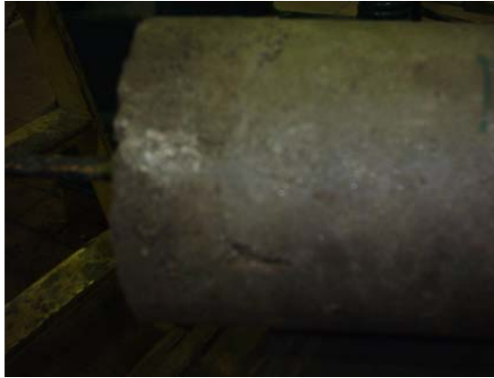
Foto 4.7. Falla por rotura del mortero.
