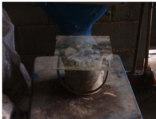
Foto 3.11. Peso unitario. Determinación del volumen del recipiente.
