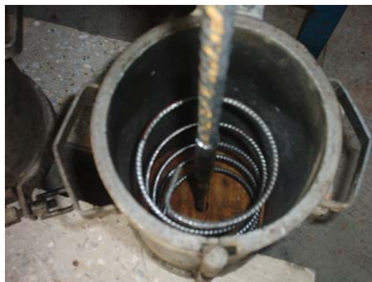
Foto 3.16. Ensayo de extracción. Armado de las probetas.
