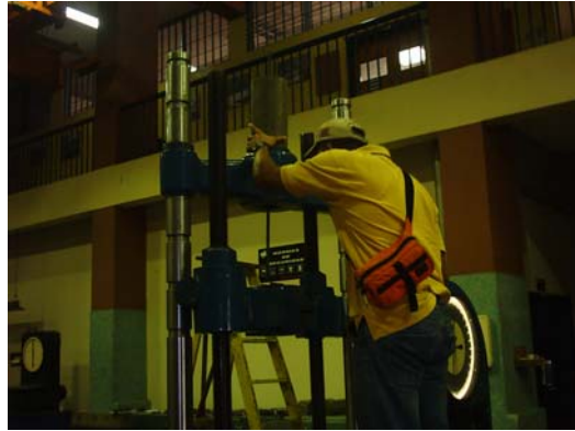
Foto 3.21. Ensayo de extracción. Alineamiento de la probeta en la máquina de ensayo.
