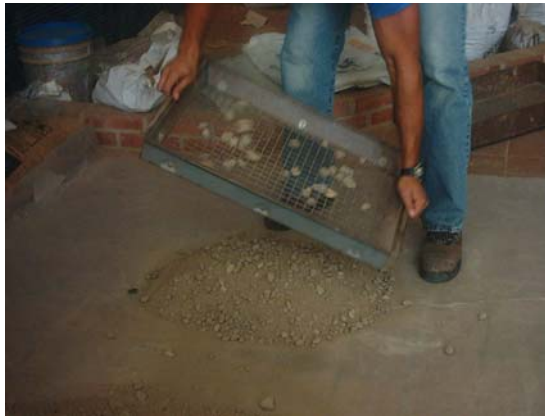
Foto 3.5. Tamizado del suelo a través del tamiz \frac{3}{4} "
