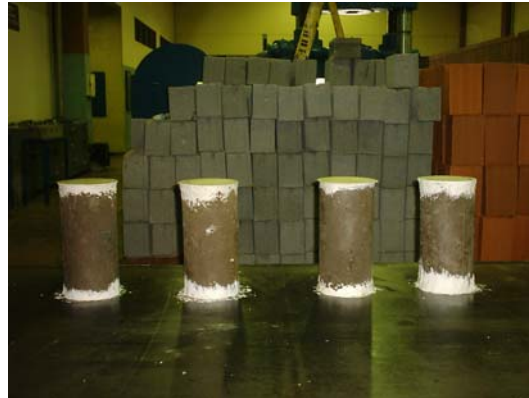
Foto 3.13. Resistencia a la compresión. Preparación de las probetas.
