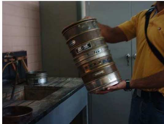
Foto 3.2. Ensayo de granulometría. Tamizado.
