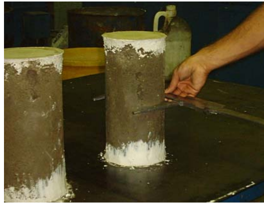
Foto 3.14. Resistencia a la compresión. Medición de las probetas.
