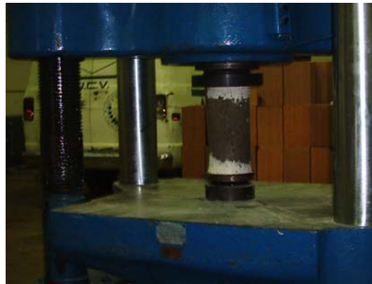
Foto 3.15. Resistencia a la compresión. Ensayo.
