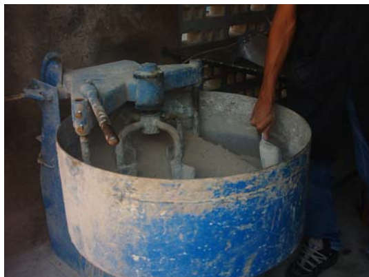
Foto 3.7. Mezclado del material seco
