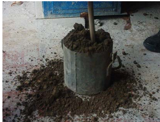
Foto 3.12. Peso unitario. Llenado de la mezcla.
