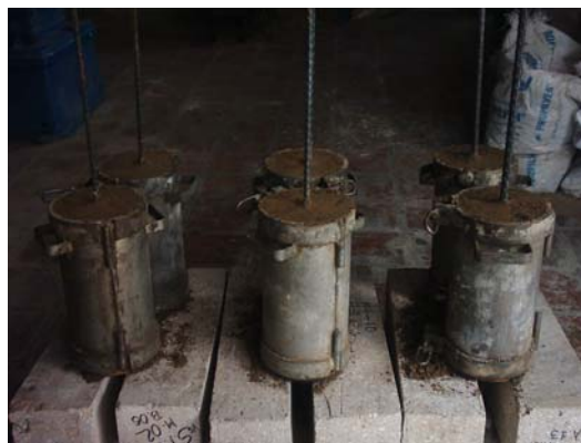
Foto 3.17. Ensayo de extracción. Almacenamiento de las probetas durante el fraguado
