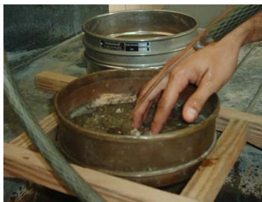
Foto 3.1. Ensayo de granulometría. Lavado sobre el tamiz N° 200.
