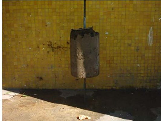
Foto 4.5. Colocación vertical de la probeta de la mezcla 1
