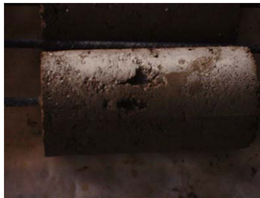
Foto 4.8. Espacios vacíos resultantes de la compactación
