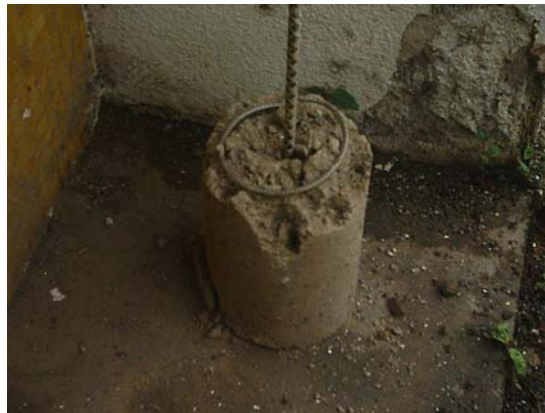
Foto 4.6. Probeta de la mezcla 1 caída.
