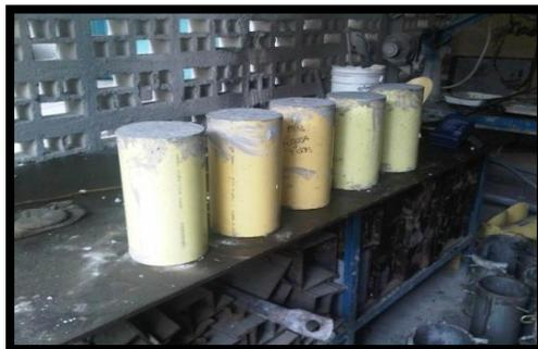
Figura IV.14: Probetas Testigo.
