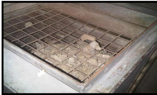
Figura IV.7: Tamizadora Mecánica.
