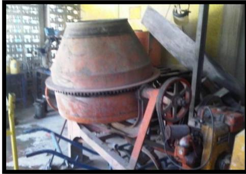
Figura IV.12: Mezcladora de eje inclinado.
