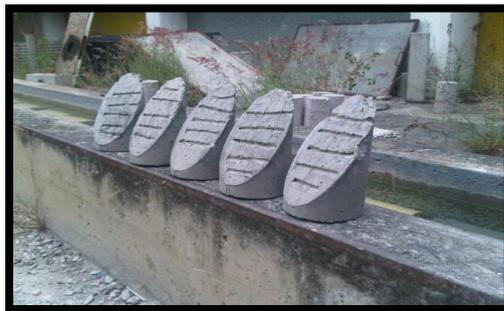
Figura IV.22: Secado de la superficie de las probetas.
