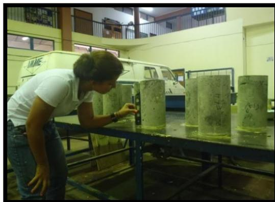
Figura IV.26: Refrentado de las probetas.
