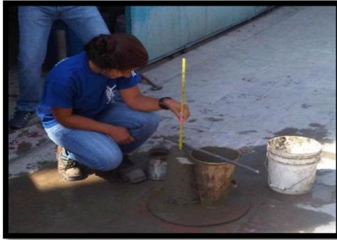
Figura IV.13: Medición de asentamiento.
