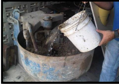
Figura IV.11: Mezcladora de eje vertical.
