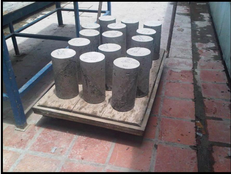
**Probetas unidas con epóxico.**
