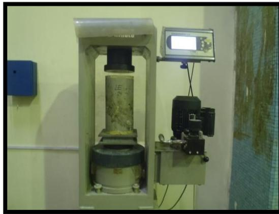
Figura IV.27: Ensayo de compresión.
