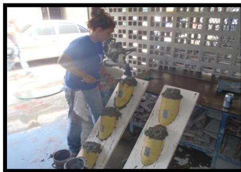
Figura IV.18: Enrasado de probetas, Etapa 2.
