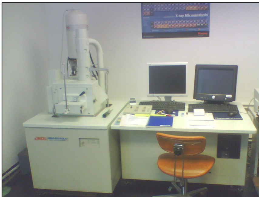
Fig 10. Microscopio electrónico de barrido (Jeol JSM-5910 LV), del laboratorio de Microscopía Electrónica, del Instituto Nacional de Geología y Minería (INGEOMIN).
