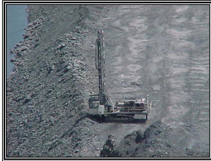
Figura 3.1. Perforación de Barrenos.
