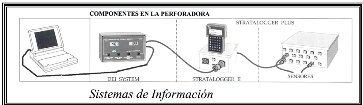
Figura 3.8. Transferencia de datos Stratalogger – Laptop.
