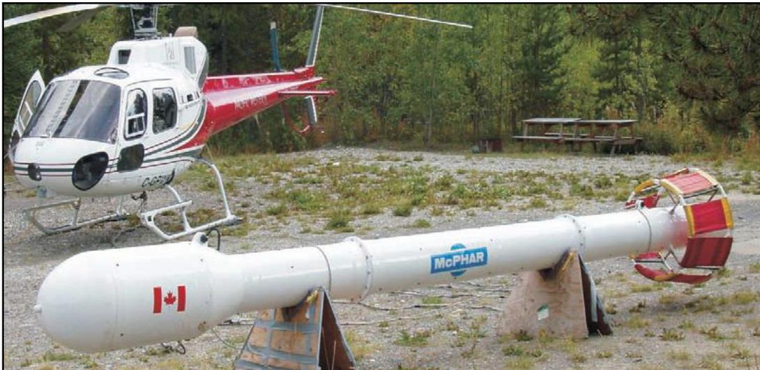
Figura N° 1.4 Equipo Humming Bird utilizado en el levantamiento aerogeofísico.
