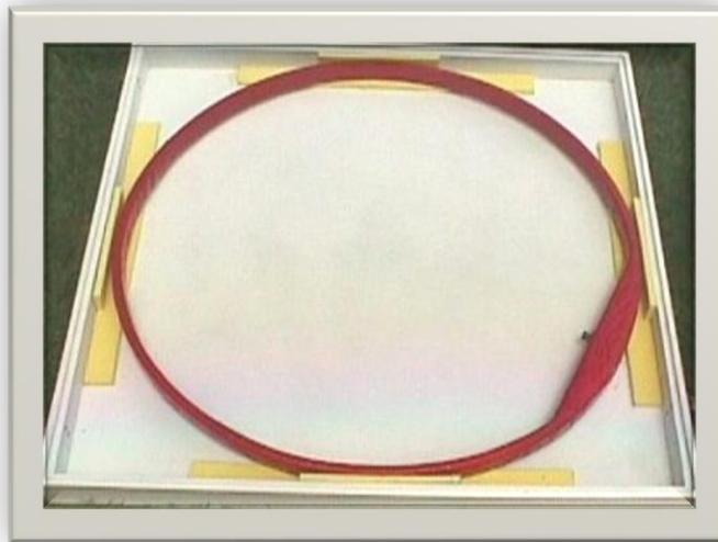
Figura N° 4.8 Bobinas del equipo FDEM-8 (tomada de [www.geoafrica.co.za](http://www.geoafrica.co.za)).
