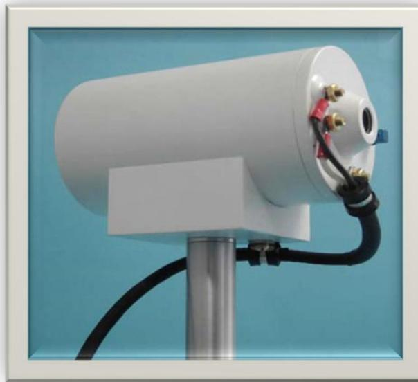
Figura N° 4.6 Sensor del magnetómetro de precesión protónica (Tomada de Geometrics, 1994).
