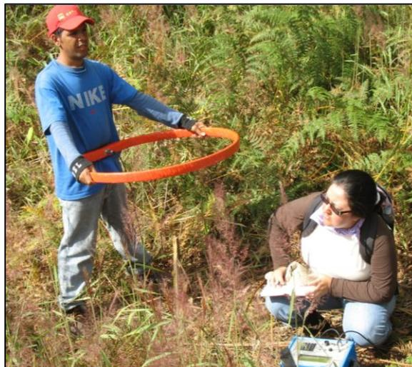
Figura N° 4.15 Adquisición de los datos electromagnéticos (configuración coplanar).
