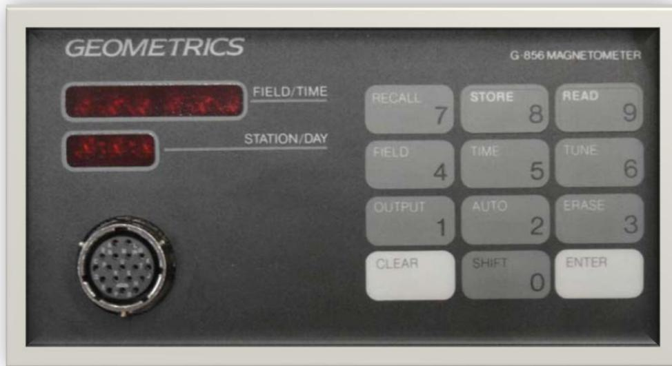
Figura N° 4.5 Panel frontal del magnetómetro G-856 utilizado en el levantamiento magnético terrestre (Tomada de Geometrics, 1994).
