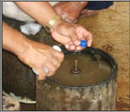
Figura 3.a y b: Preparación y amalgamación de arenas negras
