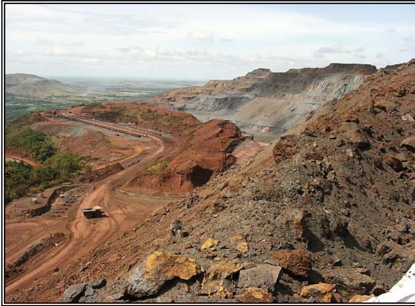
Figura 1.a: Vista de los bancos en operaciones mineras en San Isidro
