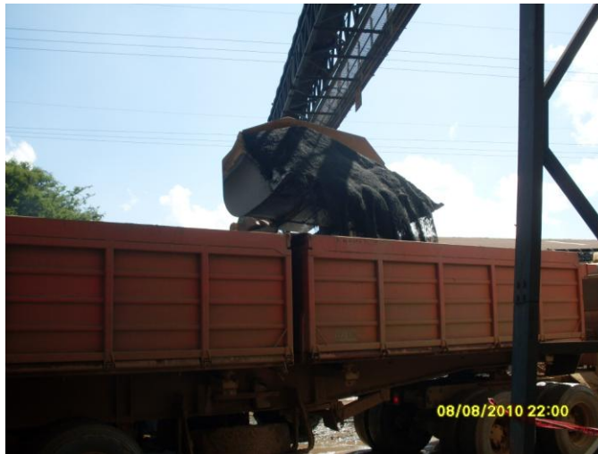
(fig. 14) Medición y observación de los tiempos en campo sobre el ciclo de carga y acarreo
