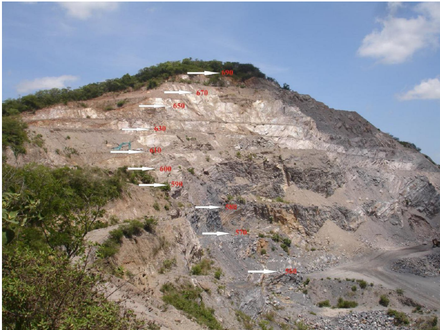
Figura N° 3. Bancos de explotación. Tomado de tesis de Yoxela Corniel.
