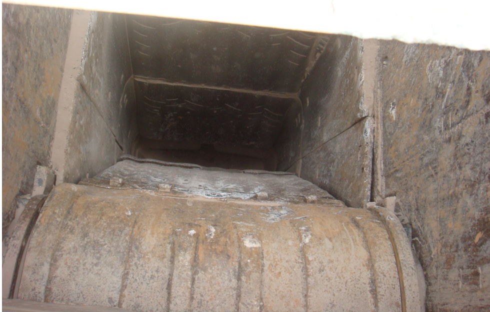
Figura N° 4. Trituradora de mandíbula (vista superior de la boca de admisión)
