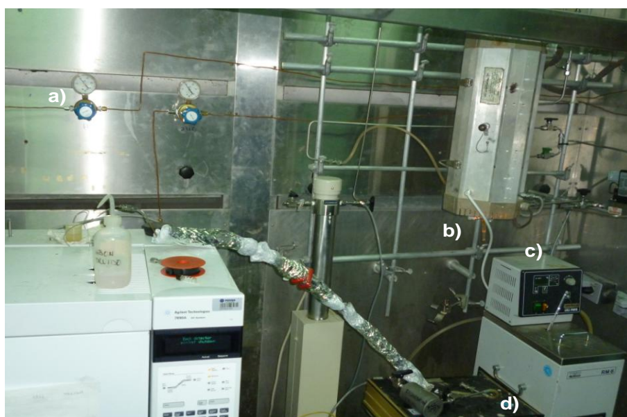
Figura 24. Arreglo experimental para la reacción de calcinación: a) Flujo de \text{N}_2 b) Reactor de vidrio c) controlador del flujo d) Controlador de Temperatura.
