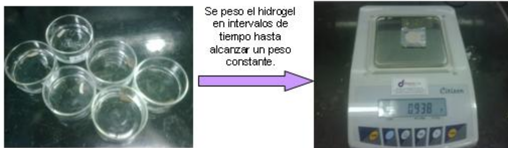
Figura 33. Medida del peso de los hidrogelos hasta alcanzar el equilibrio.
