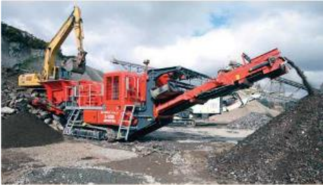
Figura 3.16: Sistema de trituradora móvil con alimentación mediante excavadora hidráulica (Fuente: Pit and Quarry, Junio 2013)
