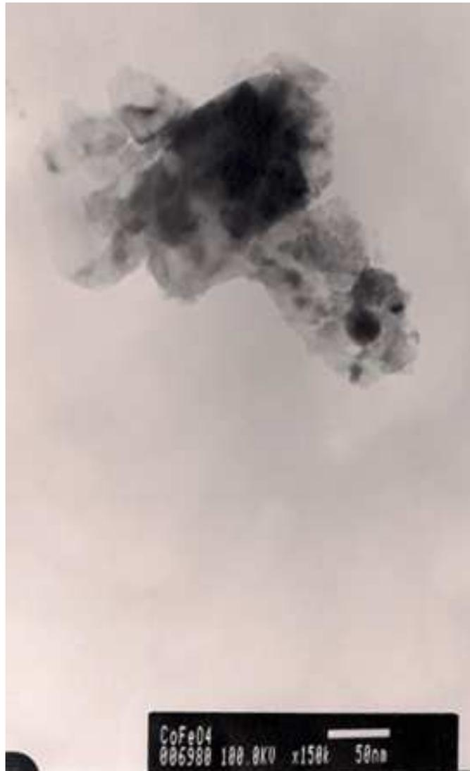
**Figura II-36.** Micrografía (TEM) de la muestra  $CoFe_2O_4$ . (x 150k) preparada por el método de combustión.
