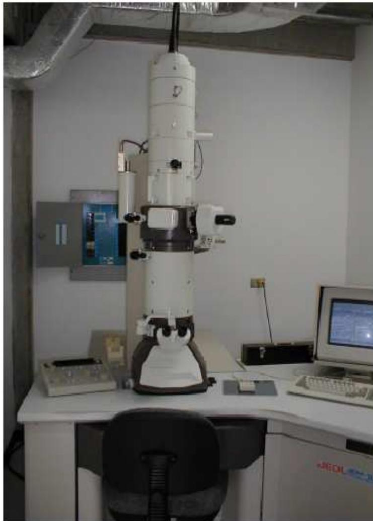
**Figura II-35** Microscopio electrónico de transmisión JEOL JEM 1220 – USB
