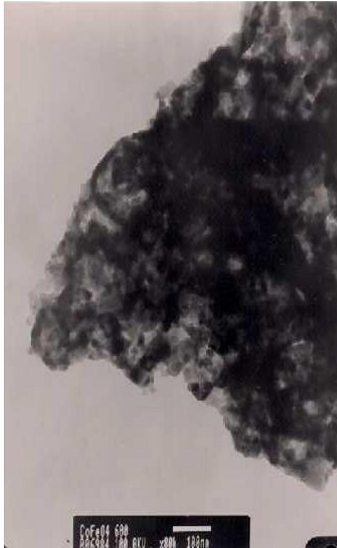
**Figura II-37.** Micrografías (TEM) de la muestra *CoFe<sub>2</sub>O<sub>4</sub> calcinada a 600°C* (x80k)
